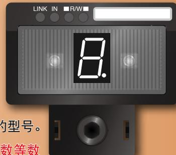
通过门开闭指示取出位置方式的POKAYOKE模组，因堵塞零部件不可取出的门口，对防止错误它是最有效的。应答操作使用橡胶杆开关。
